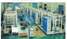
昨年4月に竣工しま した「いわき工場」 は、主に半導体工場 向けの各種水処理装 置の製造を行ってい ます。
