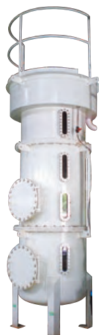
高速凝集沈殿装置パイロットプラント
